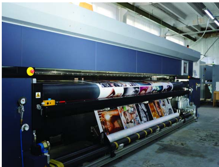
Рулонный УФ-принтер сверхкрупного формата Durst Rho 512R Plus, первый из установленных на территории России
