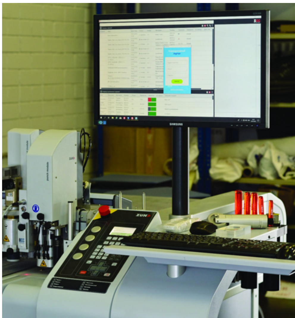
Цифровой режущий плоттер Zund S3 в демозале компании «ОктоПринт Сервис». Оборудование представлено в конфигурации для работы с текстилем и кожей.
