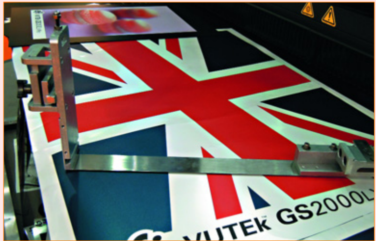
Рис. 3. Направляющие для проводки гофрированных материалов принтера с гибридной подачей.
