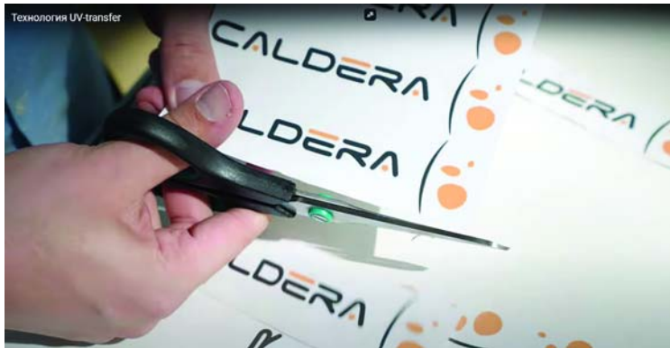
Печать УФ чернилами на промежуточном носителе с клеевым слоем
