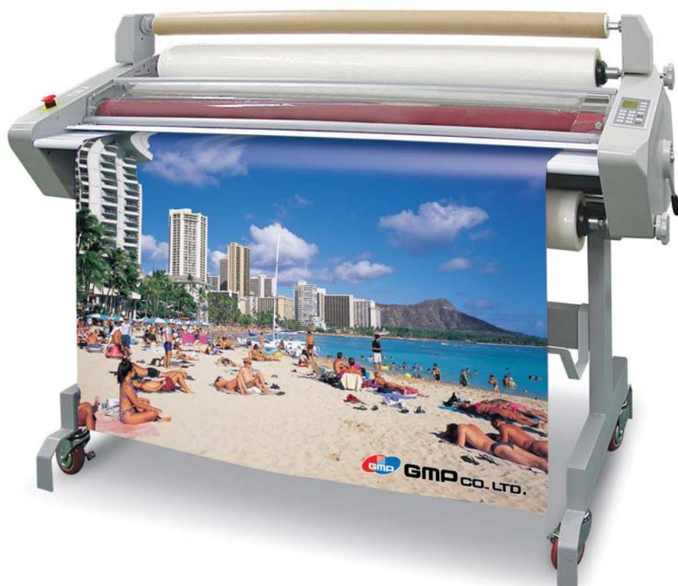
✓ Валы имеют так называемую бочкообразную форму, т.е. в середине вал имеет больший диаметр, чем на краях, что позволяет разглаживать материал во время ламинации. Стоит отметить, что силиконовая резина валов имеет запатентованный состав и обладает низкой адгезией. При должном уходе валы прослужат очень долго, а это самая дорогая часть устройства.
