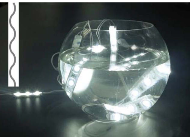
Экспериментальное погружение в воду светодиодных модулей MAKSILED серии HL.
