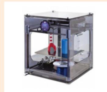
3D принтеры BFB работают на основе метода послойной добавления материалов (ALM). Принтер BFB 3D использует термопластику, нагревая материал и пропуская его через пресс для выдавливания (или печатающую головку). В итоге экструдер выталкивает очень тонкую пластиковую нить, которая наносится по горизонтальным и вертикальным координатам, слой за слоем, создавая прочный трехмерный объект.
