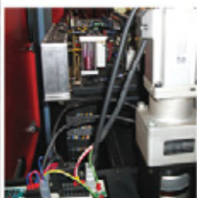
Серводвигатели установлены по осям X и Y
