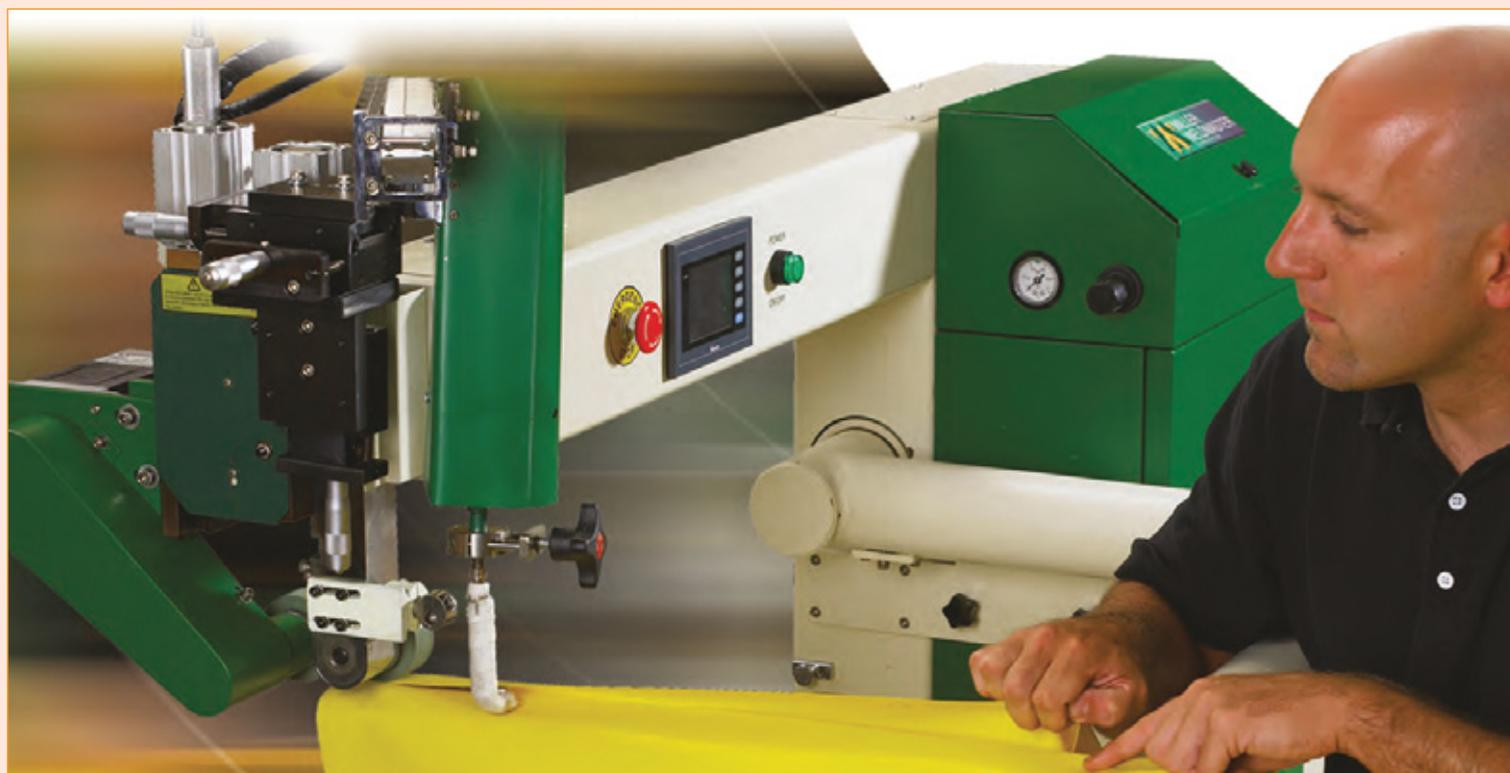
на изготовление объемных изделий, включая надувные лодки, плоты, ангары и воздухоопорные сооружения. Метод сварки баннерных полотен с их помощью схож с принципом работы швейной машины: соединяемые элементы ткани протягиваются под фиксированным сварочным порталом. Поэтому сварочные комплексы T300 и T500 особенно востребованы тогда, когда приходится выполнять криволинейное соединение термопластичных материалов в крупных объемах.
