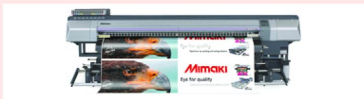
Аппарат, построенный на платформе сольвентного принтера JV5-320S, может печатать непосредственно на полиэфирных материалах шириной до 3,2 м. Чтобы предотвратить появление пятен на оборотной стороне изделий в процессе печати, принтер оснащен емкостью для сбора чернил и специальной сушкой, которая сушит чернила сразу после печати, предотвращая слипание материала при автоматической подмотке.
