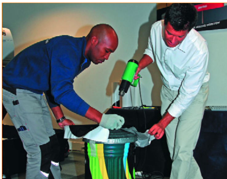
Изготовленная по технологии HP Latex графика не нуждается в последующей сушке. На фото: сотрудники барселонского подразделения HP выполняют оклейку металлической поверхности только что запечатанным на принтере HP Designjet L25500 винилом.
