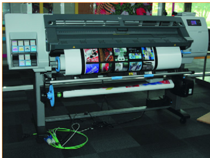
Аппарат HP Designjet L25500 с шириной печати 1,53 м в процессе печати рекламного постера.
