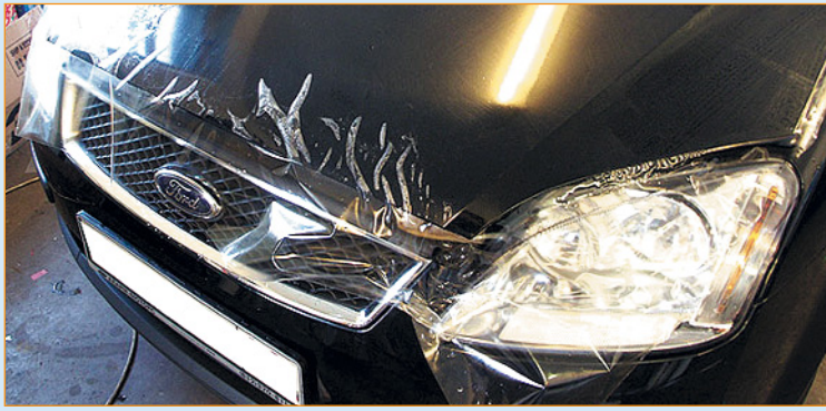
Оклеивание прозрачной (защитной) пленкой
