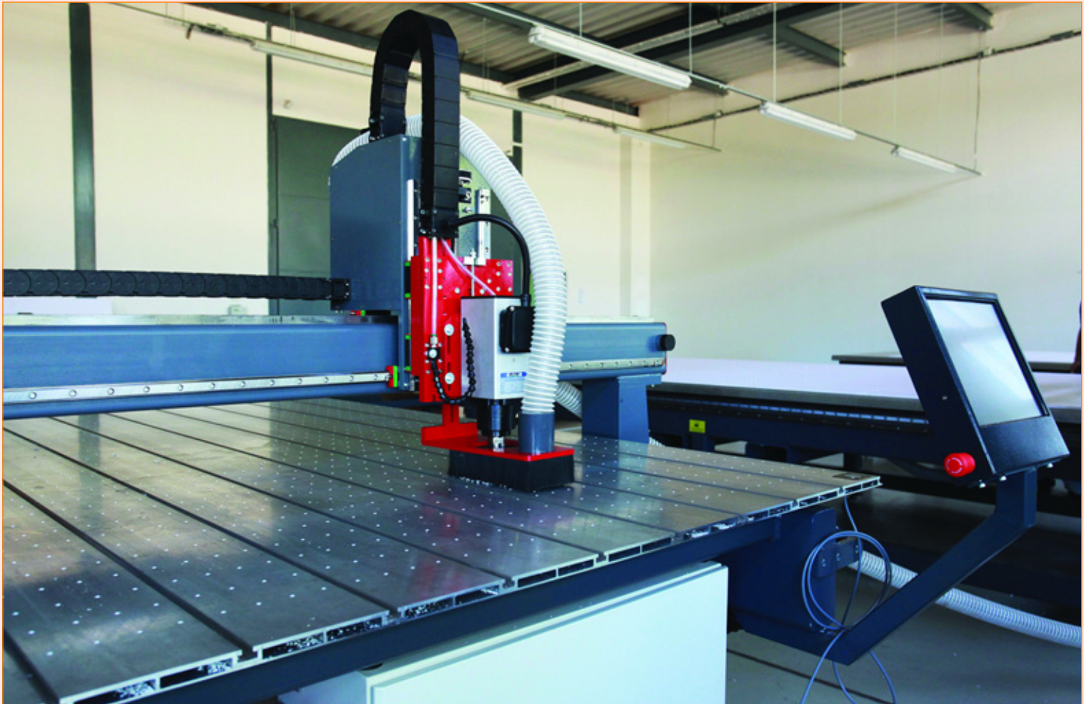
Фрезерно-гравировальный станок, оснащенный системой удаления стружки
