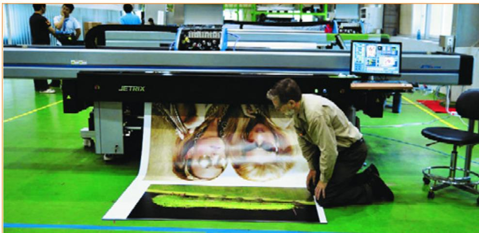
*Доктор Хельмут (Hellmuth), оценивающий качество вывода распечатанного носителя на плоттере JETRIX 2513FRQ. Ролонные носители могут собираться или на валу приемного устройства для намотки, или же выводиться непосредственно на пол.*
