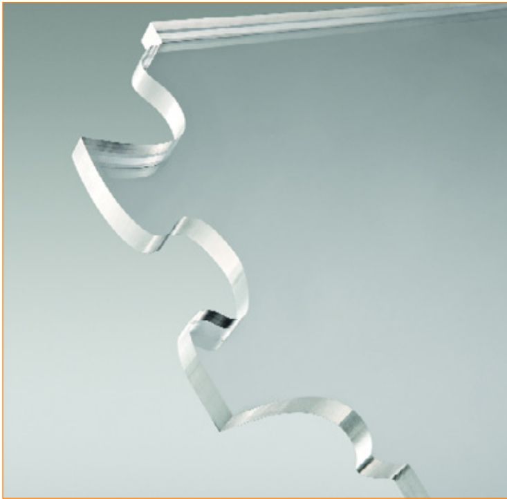
Гладкость фрезерованной кромки акрила зависит от наличия вибраций и может служить показателем жесткости системы.
