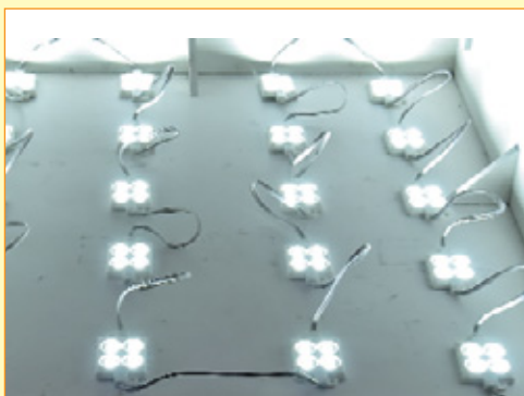
Фото #4. Стандартный способ монтажа внутренней подсветки.
