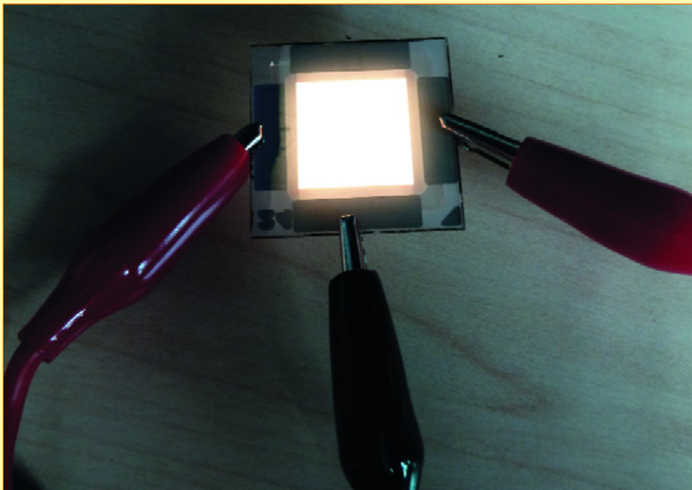
Опытный образец органического светодиода OSRAM с рекордной световой эффективностью 87 лм/Вт
