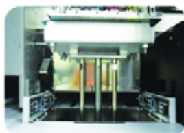
Система парковки печатающих головок на принтере PQ-3204
