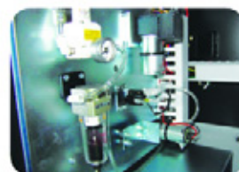
Встроенный мини-компрессор для создания отрицательного давления в системе
