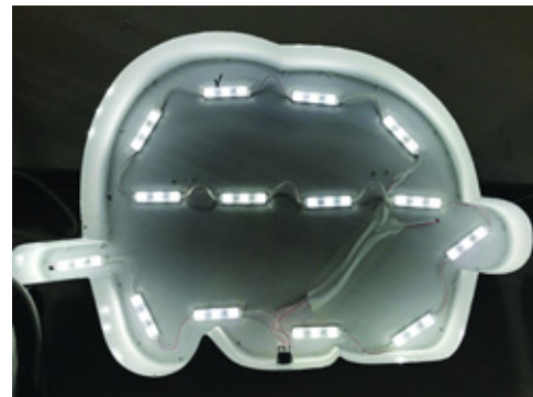
Должным образом продуманная внутренняя подсветка обеспечивает равномерную заливку светом всей лицевой поверхности вывески.
