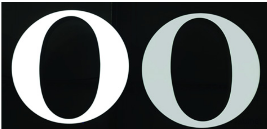
Слева: правильная раскладка светодиодных модулей, обеспечивающая равномерное свечение «лица» буквы.
