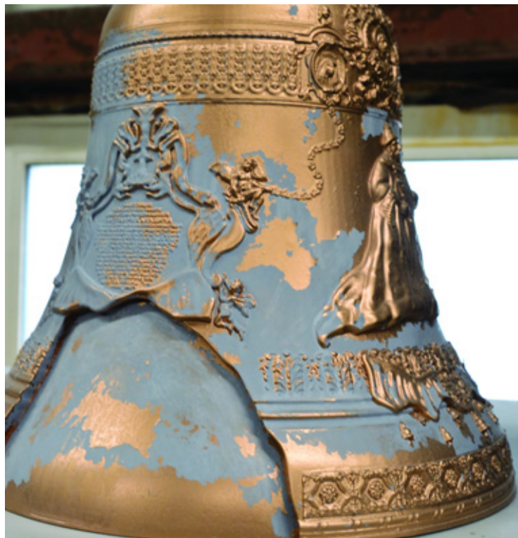
Напечатанный на 3D-принтере Massivit макет Царь-колокола в цеху компании 3D.RU по покраске трехмерных изделий.
