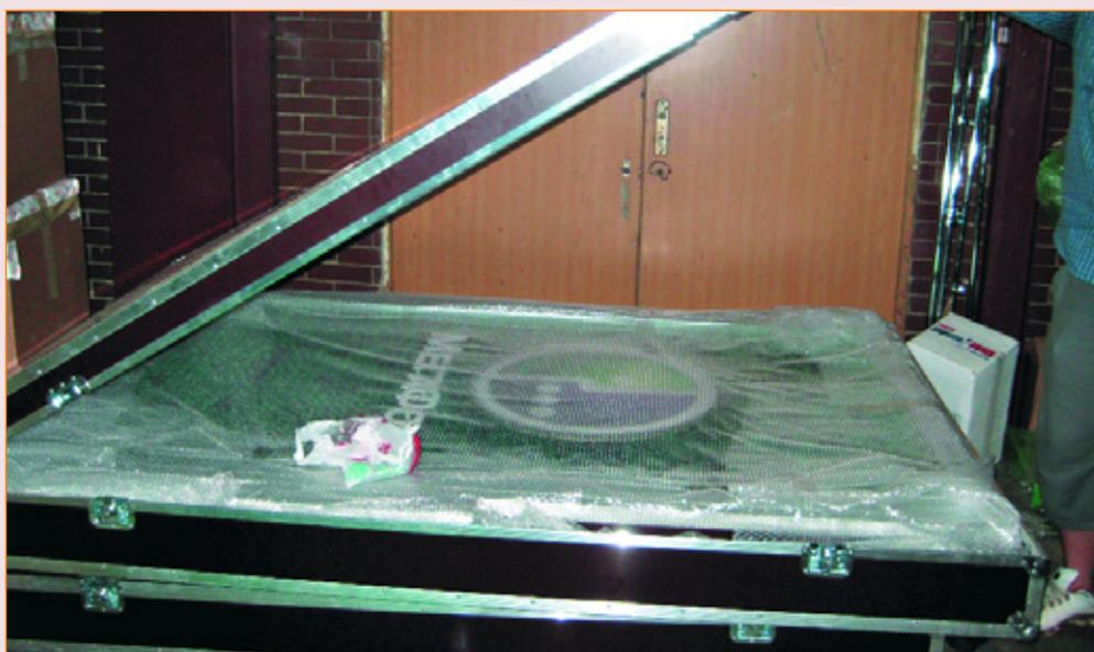
Каркасом конструкции стал алюминиевый профиль (80 мм). Для быстрой установки и удобства при демонтаже основная поверхность была сделана неразборной, а основание — быстросъемным. Для устойчивости конструкции, в случае сильных порывов ветра, в основание укреплялись листы оцинкованного перфорированного металла (4 мм). Они не только создавали необходимый баланс, но и гармонично вписывались в общую картину рекламной конструкции, придавая ей современный и законченный вид.
