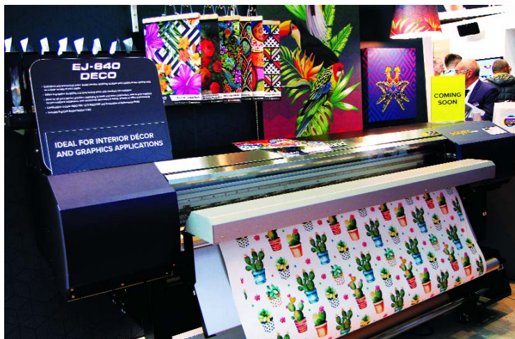
Предпродажный образец нового широкоформатного принтера Roland EJ-640 Deco на водных чернилах, который предназначен для печати обоев и других графических изделий для оформления интерьеров. Первые поставки принтера в странах Европы запланированы на конец текущего года.
