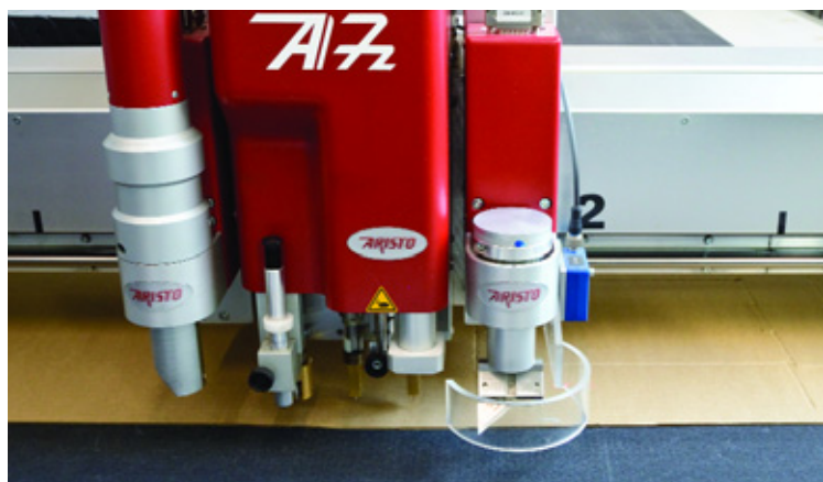
Изготовление упаковочной коробки из гофрокартона путем резки и биговки
