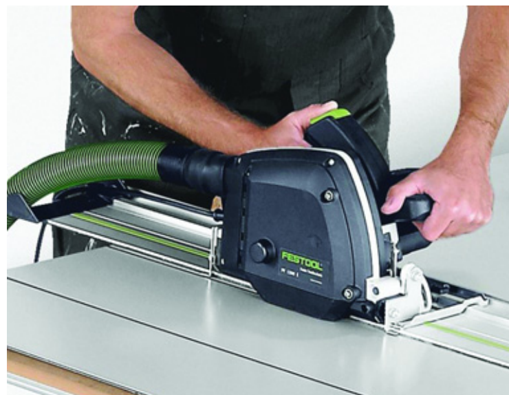
Дисковый фрезер Festool для обработки АКП
