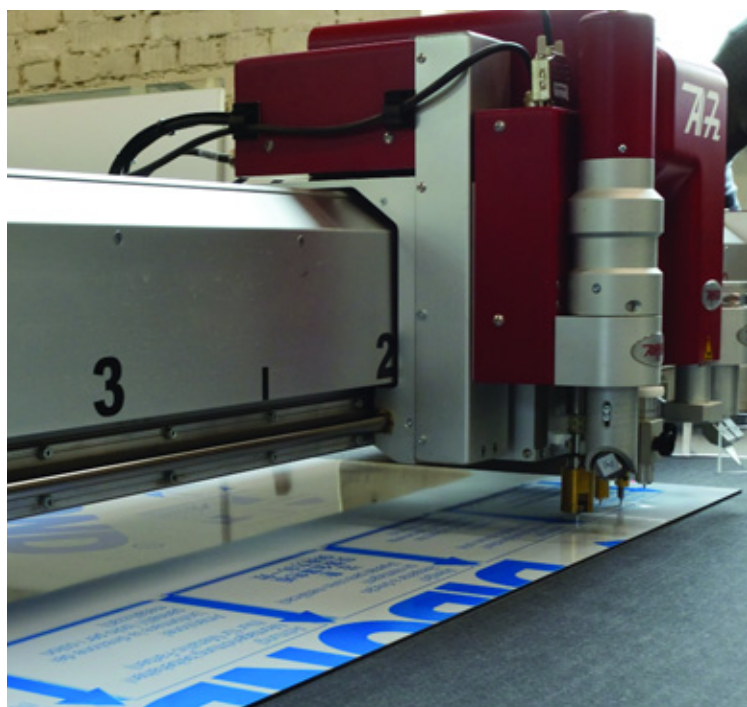
Раскрой алюминиевой композитной панели Dibond с помощью осциллирующего ножа
