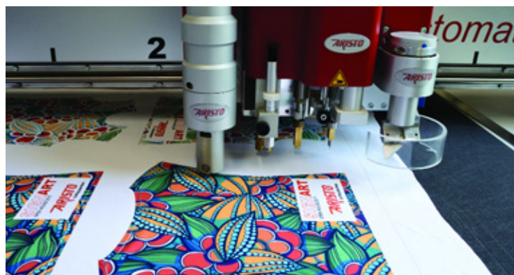
Применение дискового ножа для раскроя текстиля
