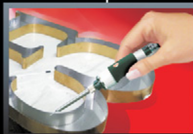
Пайка корпусов букв и лазерная сварка
