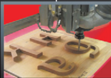
Изготовление пресс-форм для формовки лицевых частей букв
