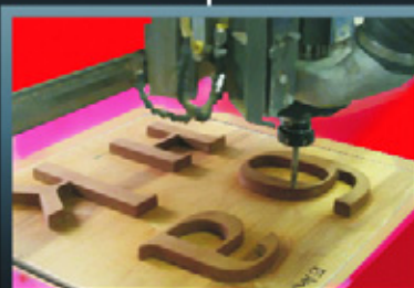
Изготовление пресс-форм для формовки лицевых частей букв
