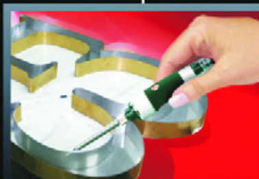
Пайка корпусов букв и лазерная сварка
