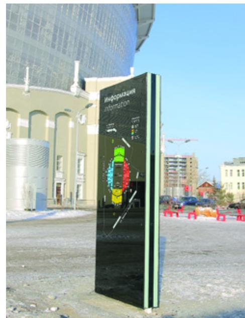
каркас, а облицовка сделана композитными панелями. Все надписи и элементы выполнены методом инкрустации, торцы конструкции изготовлены из акрилового стекла 10 мм, подсветка осуществляется светодиодными модулями.
