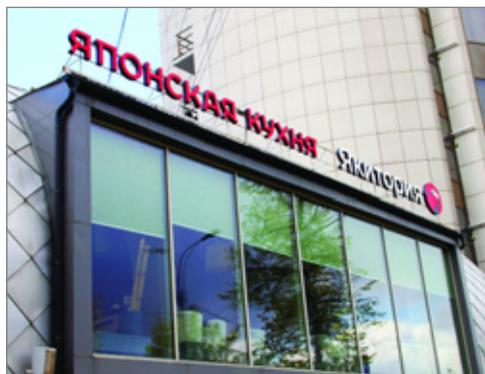
Лицевая поверхность логотипа выполнена из молочного акрила с нанесением пленки. Основа конструкции, «рука» и боковые поверхности изготовлены из нержавеющей
