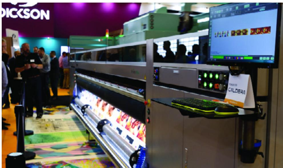
*Рулонный УФ-принтер сверхкрупного формата Fujifilm Ultra, печатающий чернильными каплями объемом 3 пл со скоростью в 236 кв. м/ч.*
