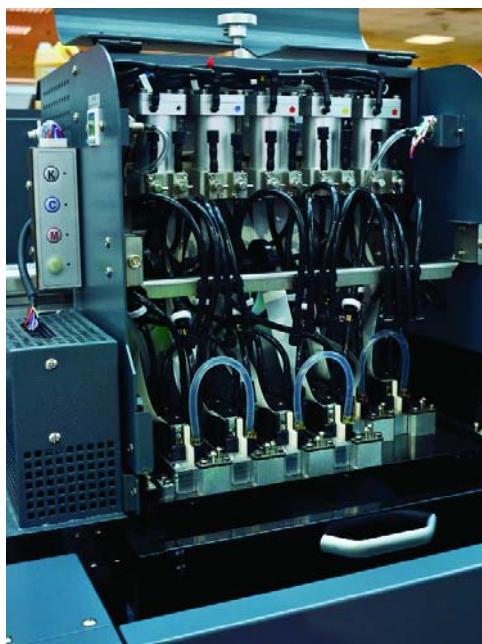
Печатающая каретка в схеме СМУК+W+W
