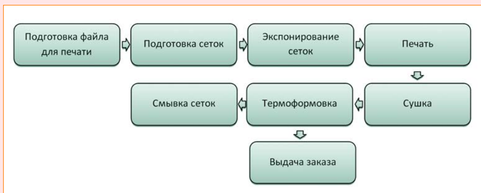
Схема аналогового процесса печати для термоформовки
