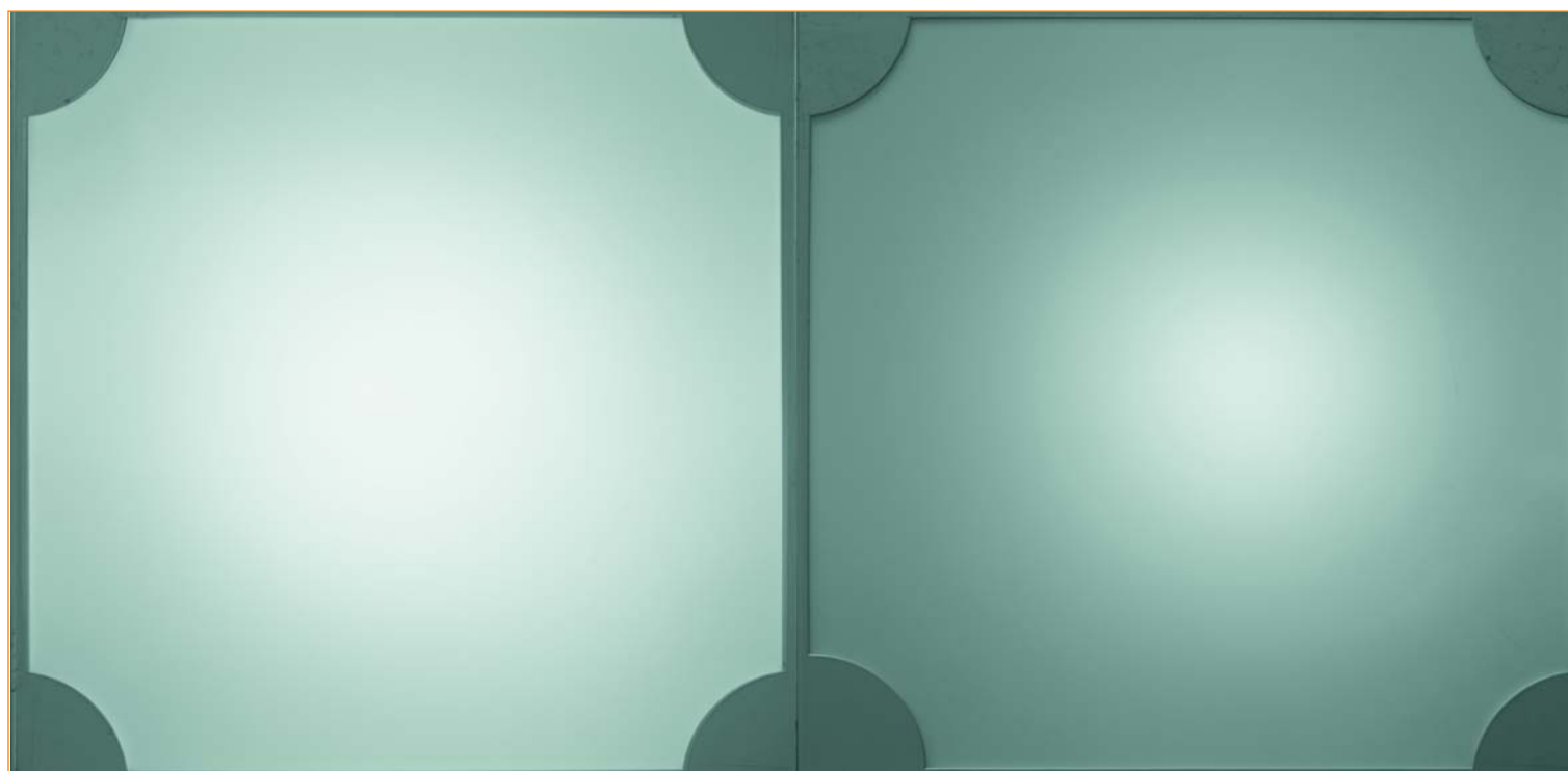
Сравнение светового пятна на глубине 10 см. ELF SOL III (слева) и обычный модуль 3 диода с линзами (справа)
