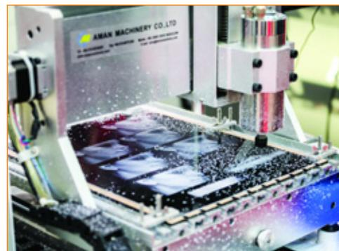
преобразуются в задание для фрезеровки, а передача различных оттенков и полутонов достигается за счет варьирования глубины реза фрезы. Если учесть массовое распространение «сэлфи» и растущую популярность персонализированных изделий для рядовых потребителей, появление новой функции в станках Aman действительно своевременно и предоставляет пользователям возможность увеличить объемы выполняемых заказов.
