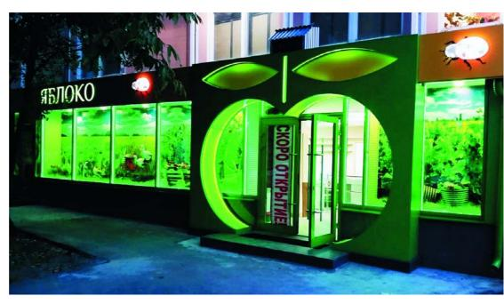
поверхность — ПВХ с пленкой Oracal 641. Задняя стенка — ПВХ. Внутренняя подсветка — светодиоды. И световой формованный декоративный элемент «БУКАШКА» размером 750 х 450 мм. Формованный элемент из молочного полистирола с полноцветом (пленка с ламинацией). Задняя стенка — ПВХ. Внутренняя подсветка — светодиоды.
