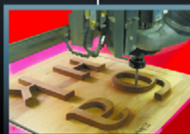
Изготовление пресс-форм для формовки лицевых частей букв
