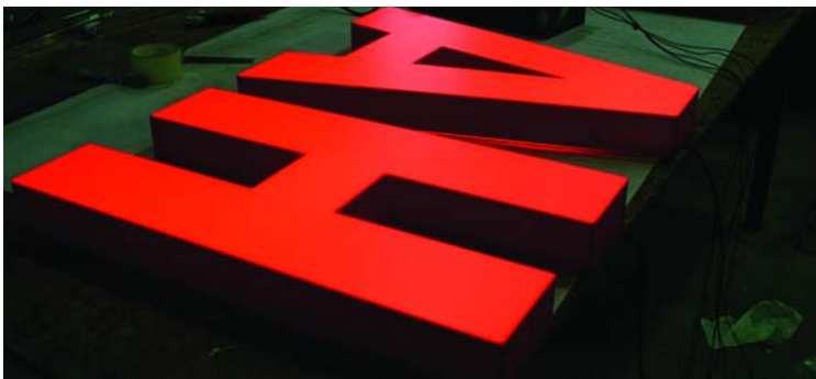
Готовые объемные буквы с боковинами из ПВХ и светодиодной подсветкой.
