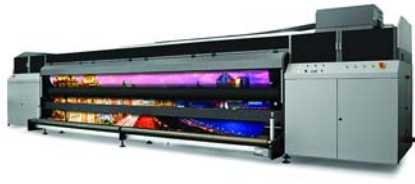
Широкоформатный рулонный принтер HANDTOP HT5000UV
