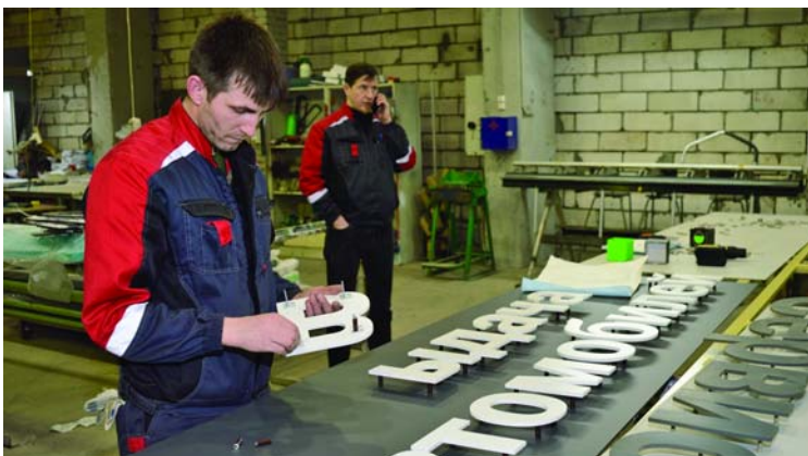
Фиксация крепежных элементов на тыльной поверхности букв для интерьерной нецветовой вывески автосалона.
