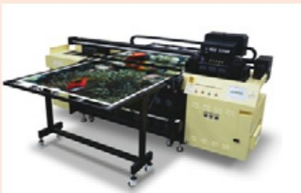
Аппарат оснащен восемью печатающими головками Konica Minolta, причем для нанесения чернил традиционных цветов CMYKcLm используются Konica Minolta 512M с размером капли 14 пл, а для работы с белым цветом применяются головки Konica Minolta 512L с размером капли 42 пл. Это предотвращает засыхание краски в соплах, поскольку чернила белого цвета отличаются повышенной вязкостью.
